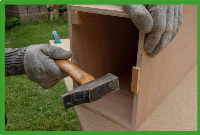
La plaque amovible sera insérée dans le tunnel. Afin d'éviter qu'elle ne glisse d'un côté ou de l'autre, **il faut fixer de chaque côté du socle du tunnel 2 petites cales en bois**. Elles mesurent env. 2cm de long par 1,5cm de haut.
